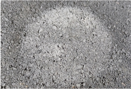
Abbildung 1: Kalkausblühung unter Laborbedingungen. Benebelung über 24 Stunden bei 50°C.
